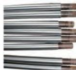
Сварочные трубки для изготовления роликов закупаются у известных производителей. Эллиптичность ниже 0.8 мм. Прямолинейность составляет 0.15%. Допуск по толщине составляет +/- 0.1 мм. Толщина стенки составляет от 2.5 мм до 6 мм. Диаметр трубки составляет от 50 мм до 219 мм, в основном для изготовления обычных роликов.
